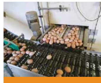
Sistema de recogida de huevos con doble cinta, cada una de 25 cm, y con una separación central, para reducir las fisuras finas y permitir que se acumulen más huevos en ellas, un detalle importante cuando se opera con empacadoras.
