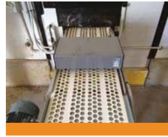
Una sola cinta de 40 cm en una fila de nidales comunales, con un contador al final. Los sistemas mal ajustados pueden causar fisuras adicionales en los huevos.
