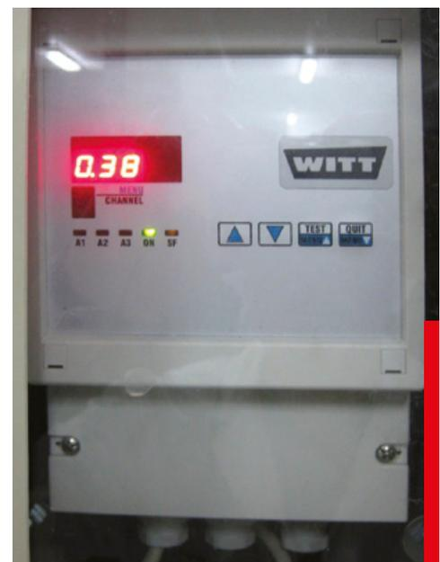
Aturridor por gases de aves que muestra y registra la concentración de gas (CO<sub>2</sub>) y el tiempo de exposición.
