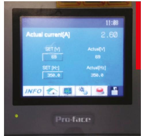
Aturridor eléctrico de aves que muestra y registra la intensidad (Amperios), la frecuencia (Hz) y el voltaje (voltios).
