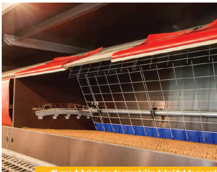
Cierre del sistema de expulsión del nidal de un aviario
