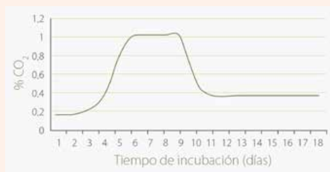
Fig. 1. Evolución de los niveles de CO 2 en la incubadora. Unos niveles iniciales más elevados de CO 2 tienen un efecto positivo en el desarrollo del sistema cardiovascular.
