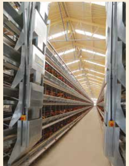
Alimentador tipo tolva el pienso expulsa el pienso directamente en el comedero. (Imagen cortesía de Alaso)
