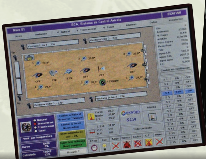
El ordenador SCA, con toda la información recogida para el control ambiental de la nave.
