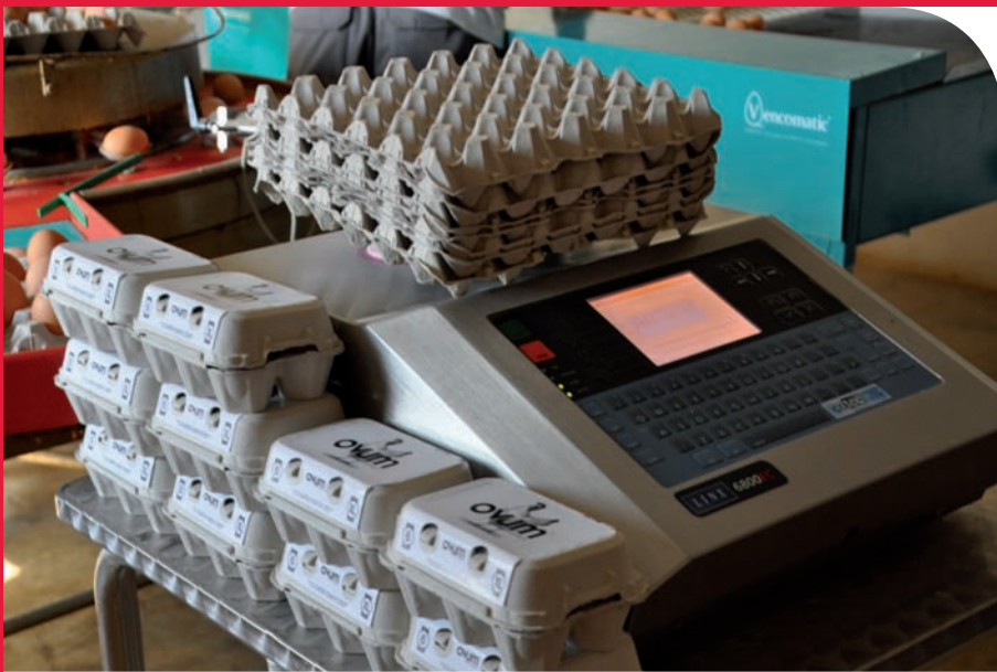
Poseen una marcadora Linx adaptada a la clasificadora Royo. En primer plano, el estuche de Ovum.
