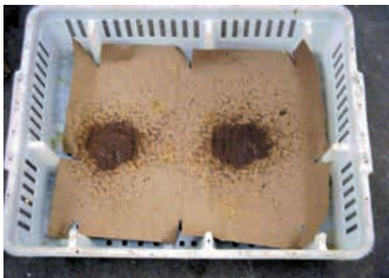
Patrón de spray inadecuado.
