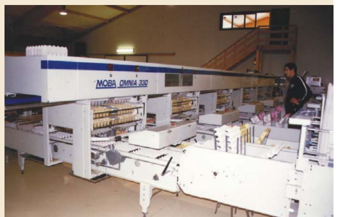
La clasificadora de Moba "Omnia 330", en operación.
