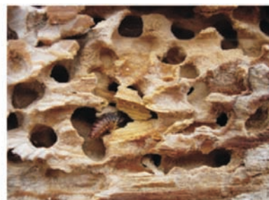
Daños en aislamientos y estructuras ocasionados por A.diaperinus .
