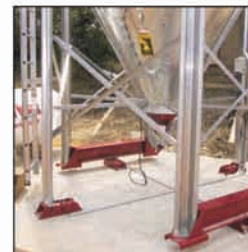
Silos con células de carga
