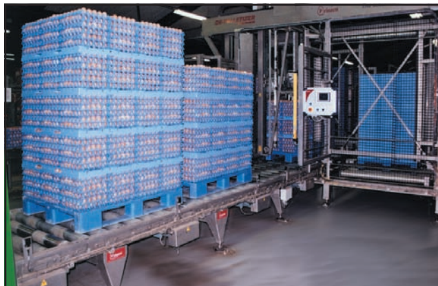
La entrada de huevos en una "De-Palletizer", para proceder a su clasificación, en el centro de embalaje.
