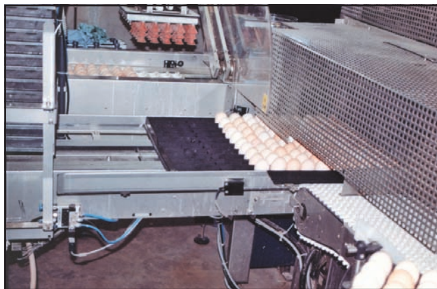
La colocación de los huevos para incubar en las bandejas de las máquinas de carga también se realiza automáticamente.
