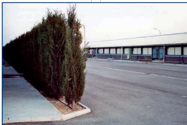
Un amplio espacio entre las naves, pavimentado y con un seto frente a las salidas de aire de una de ellas es ideal para evitar contaminaciones. (Foto archivo de la Real Escuela de Avicultura)
