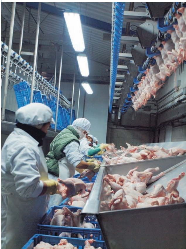
Clasificación automática de las canales, por su peso
