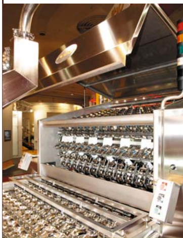
La cascadora Syncro de PELBO procesa hasta 180.000 huevos/hora.
