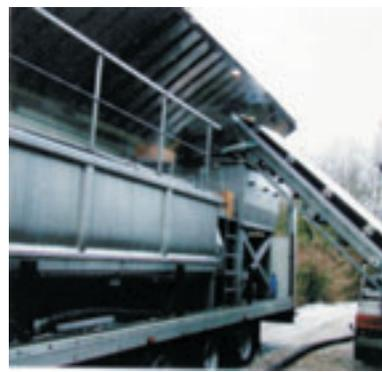
Una vez preparada la pulpa, la mezcladora puede ser descargada a un camión tanque y toda la máquina puede ser limpiada.
