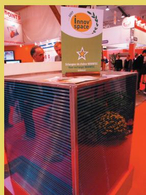
La firma francesa Sodalec ha lanzado al mercado un intercambiador de calor. Este sistema permite recuperar las calorías del aire extraído de las granjas. En las naves de pollos o ponedoras la ventilación extrae el aire interior a una temperatura superior a 20°C, permitiendo el intercambiador WARMTEC recuperar estas calorías para precalentar el aire frío exterior, que en invierno se introduce en ellas, reduciendo así las necesidades de calefacción.
