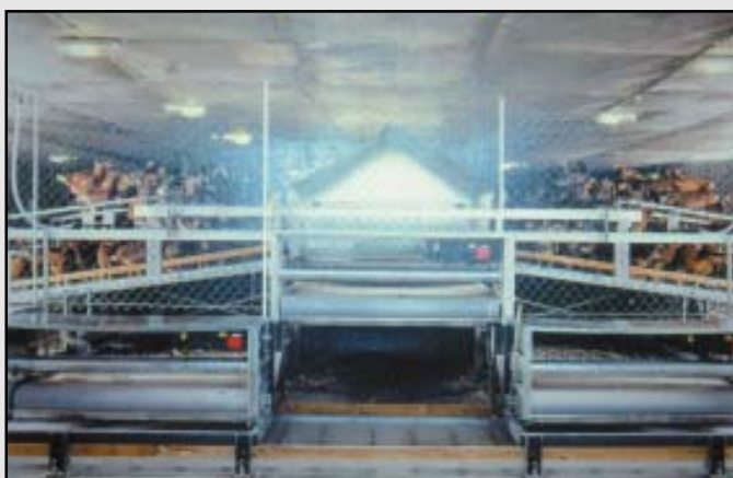
Slats inclinados a ambos lados del ponedero central. En este caso, la yacija se recoge periódicamente mediante cintas transportadoras situadas bajo aquéllos, un lujo que no está al alcance de pequeñas instalaciones. (Foto archivo)
