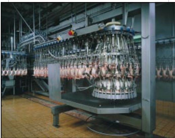
Cadena de evisceración automática. (Foto gentileza de Stork PMT, B.V.)
