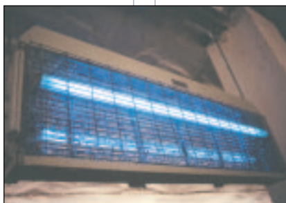
Electrocutor de moscas, un eficaz medio para reducir la población de éstas en un gallinero. (Foto archivo de la Real Escuela de Avicultura)
