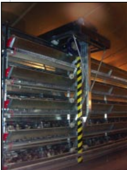
Batería enriquecida de 4 pisos, de la firma INSAVI, C.B., de Reus.
