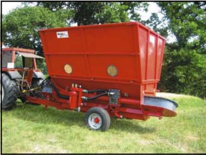
nave, lo que se realiza a través de una tubería elástica y de un motor que expulsa el material a presión. Esto representa una importante ventaja sanitaria ya que puede utilizarse incluso con animales dentro de la nave. Asimismo, permite inyectar productos para tratar la viruta o paja (fungicidas, bactericidas o virucidas).
