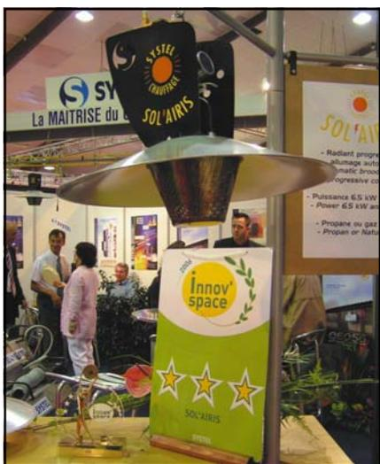
El calefactor "Sol'Airis", de la empresa francesa Systel, una campana a gas, de infrarrojos, de combustión progresiva desde 20 hasta 1.400 mbar, comandado por un servomotor pilotado por el ordenador de la calefacción. Gracias a ello, su potencia calorífica aumenta o disminuye de forma progresiva, consiguiéndose un interesante ahorro de gas.
