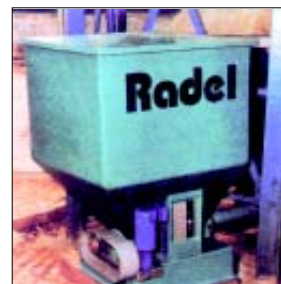
Dosificador de calcio sobre los comederos para gallinas, de RADEL.
