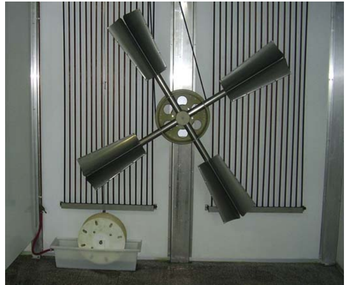
Detalles interiores de una incubadora Pas Reform: el ventilador-distribuidor de aire, los tubos de calefacción-refrigeración y, en el suelo, la cubeta de humidificación.
