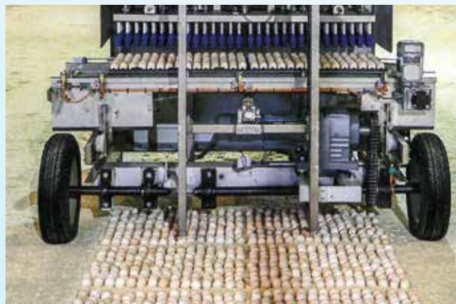
Con dos bandejas de 150 ventosas, el robot de NestBorn emplaza 50.000 huevos por hora en la cama de viruta que los mantiene en posición vertical hasta el nacimiento.
