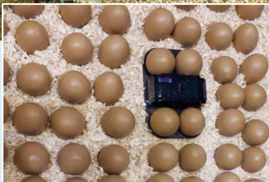
Los sensores OvoScan supervisan continuamente la temperatura de la cáscara, del aire y de la humedad.
