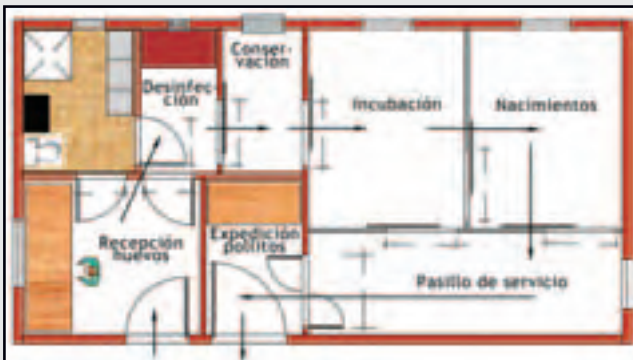
Más grande o más pequeña, el diseño de la sala de incubar debe respetar el recorrido que ha de tener el huevo incubable. (Proavial)
